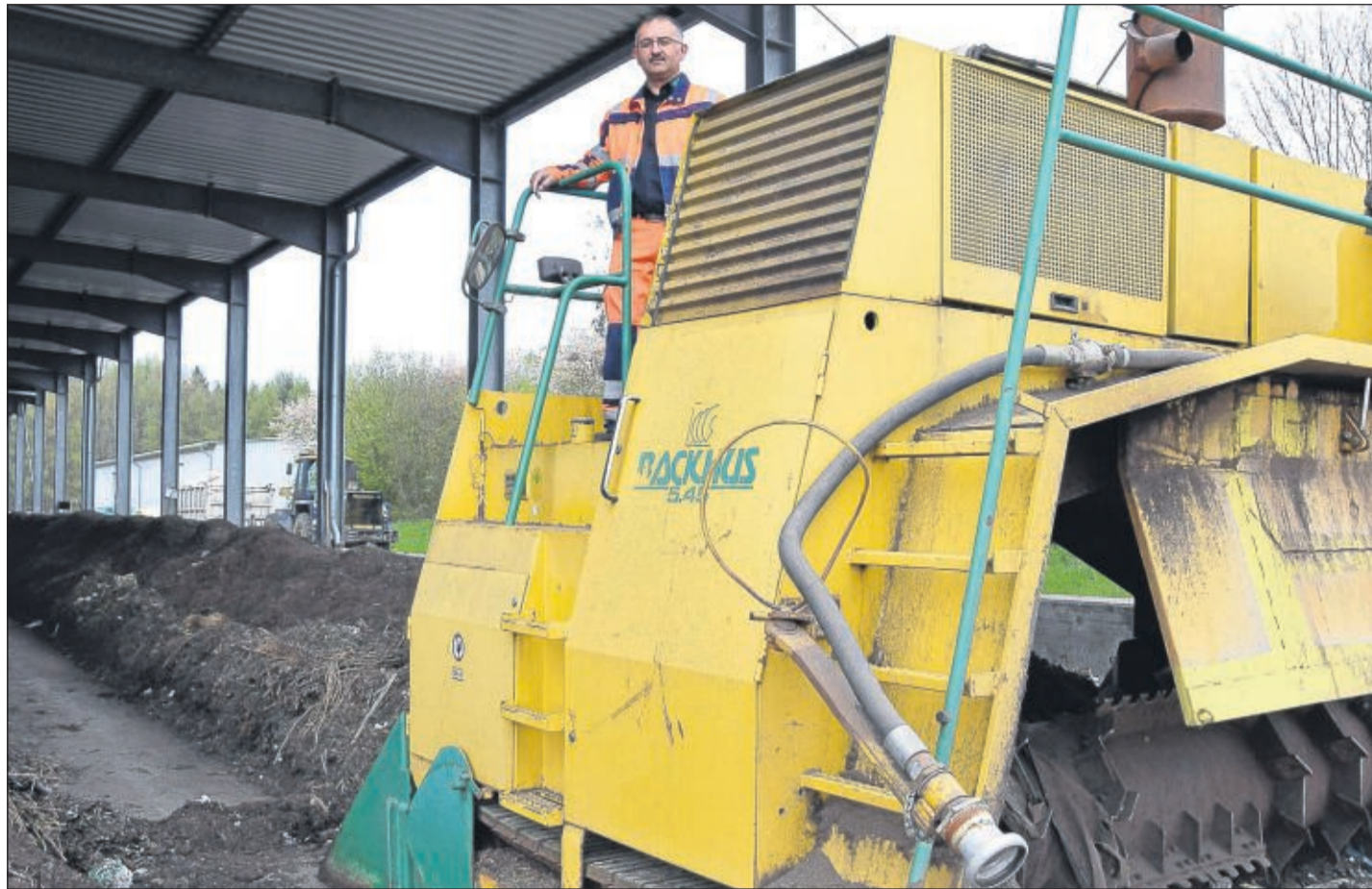
Wälzt den Kompost um: Kenan Yilmaz, Mitarbeiter der Abfallentsorgung Kreis Kassel, auf dem Umsetzer der Kirschenplantage Hofgeismar. Nur auf der Hofgeismarer Deponie wird der Bioabfall offen in der so genannten Mietenkompostierung verarbeitet. Durch das Umwälzen verrottet er schneller.
